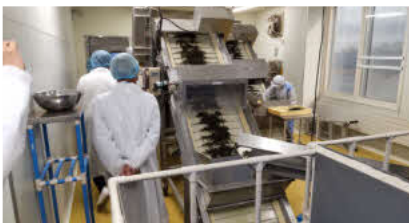
異物混入防止のためベルトコンベアーを流れる「きざみ昆布」
