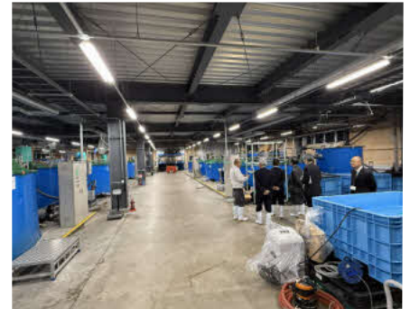
8基の水槽が並ぶ施設内。IoTにより基本的に一人で管理している
